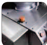
Oliereservoir van buitenaf bij te vullen en met verklikkerlichtje voor oliepeil
